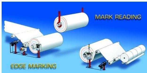
Représentation ci-dessus d'une installation avec marquage avant bobinage et lecture des séquences de marquage au déroulage
