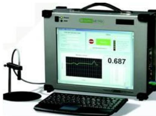
Systèmes de mesure en ligne des couches de vernis sur et dans les boîtes de conserve et canettes aluminium.
